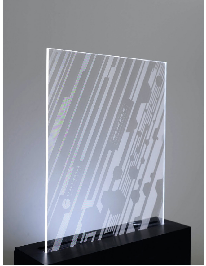
Die filigranen Strukturen, die der Femtolaser mit Radien von 0,01 mm einbringt, werden erst bei Licht sichtbar. © Reichle
