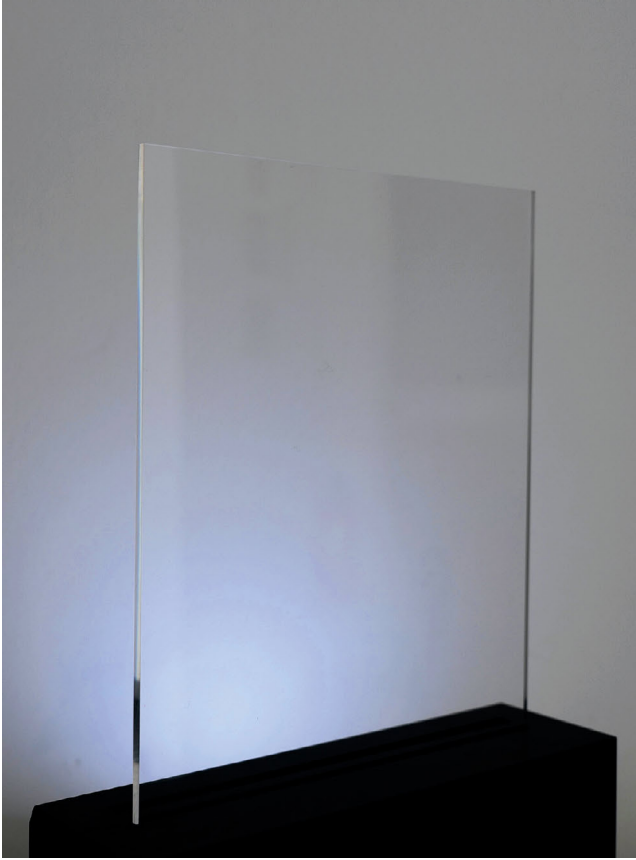
Die filigranen Strukturen, die der Femtolaser mit Radien von 0,01 mm einbringt, werden erst bei Licht sichtbar. © Reichle
